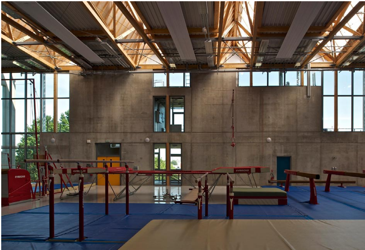
Ambiance intérieure niveau 3 - la toiture en « sheds » apporte la lumière naturelle dans toute l'épaisseur de la salle
